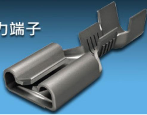
TE Connectivity (TE)推出FASTON产品系列的新型低插入力端子，采用新的人体工程学设计，易于使用，并提供高温或黄铜2种选择以实现设计的灵活性和提高效率。适合高温下使用的低插入力FASTON端子的最大插入力仅为8磅 ( 36N )，最高使用温度高达250°C。黄铜低插入力FASTON端子的最大插入力仅为6磅 ( 27N )，最高使用温度最高为105°C。
